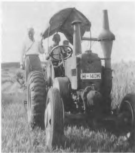
Die Zugmaschine mit dem Ein-Zylinder-Glühkopf-Zweitaktmotor, meinem Vater und mir am Steuer und dem Münchener Besuch als Beifracht. Der Bulldog mußte zum Start mit der Lötlampe vorgeglüht und mit dem auf das Schwungrad aufgesteckten Steuerrad per Hand angeworfen werden. Bei falscher Laufrichtung wurde die Treibstoffzufuhr bis fast zum Stillstand gedrosselt, dann wieder freigegeben.
