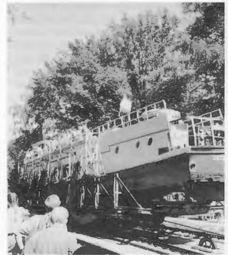
Auf dem Oberländischen Kanal (Elbingkanal). Um den Höhenunterschied zwischen Elbing und Osterode (107 m) zu überwinden, werden die Schiffe auf Schienen über die schiefen Ebenen („Rollberge“) durch Wasserkraft gezogen. Foto: Bläsing
